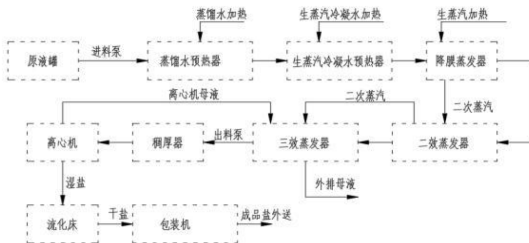
氯化钠蒸发结晶工艺流程图
