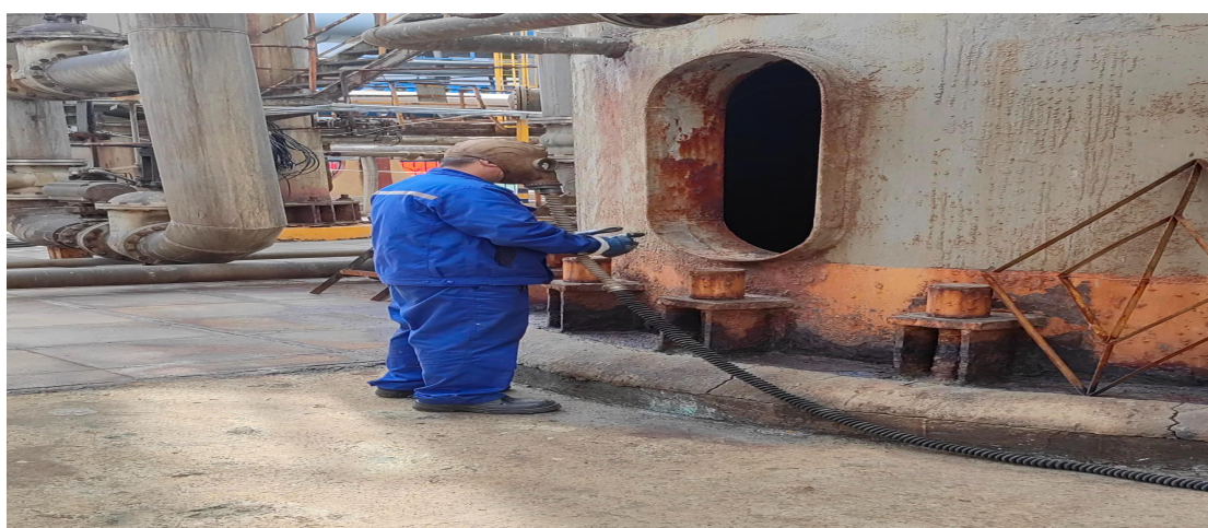
②当班操作人员发现漏点后，佩戴长管式呼吸器对漏点部位进行确认
