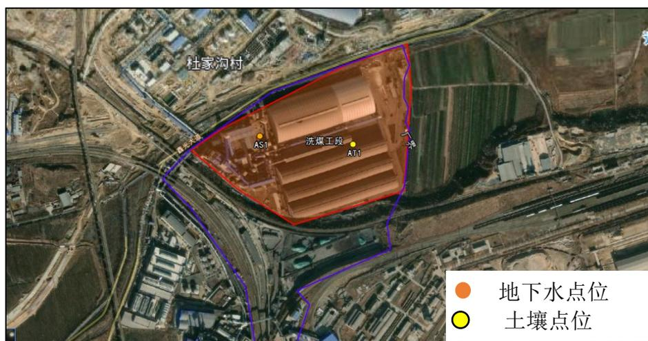
图 6.2-1 洗煤厂土壤和地下水点位布设图
